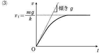
【指針】 小球が落下をはじめるときは、小球には鉛直下向きの重力だけがはたらく。しかし、しだいに下向きの速さが増加するにつれ、鉛直上向き (進行方向と逆向き) に空気の抵抗力  $kv$  [N] がはたらき増加していく。このため、下向きの合力はしだいに小さくなり、加速度も小さくなる。やがて空気の抵抗力が重力と等しくなると、合力が0になるので加速度も0になり、速度が一定になる。
