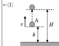
最高点での A の速さは 0 であるから, 床を位置エネルギーの基準水平面として, 力学的エネルギー保存則は図より
