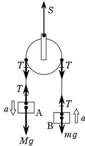
[解説] (1) 図 a に示すように、A の下降距離  $x$  に対して、動滑車の上昇距離 (= B の上昇距離) は  $\frac{x}{2}$  となる。したがって、等加速度直線運動の式
