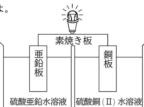
(2) 図のような装置を組み立て、4.00 A の電流で 32 分 10 秒間電気分解した。
