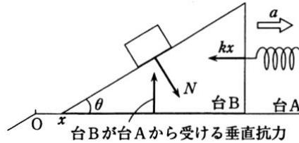
台Bは $x$ 軸方向(水平方向)に運動するので、台Bに働く力の $x$ 軸方向の成分に着目すると、台Bの運動方程式は $N \sin \theta - kx = Ma$
