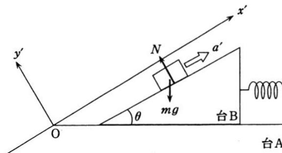
小物体の加速度を $x'$ 軸方向の成分を $a'$ とし、小物体に働く力の $x'$ 軸方向の成分に着目すると、小物体の $x'$ 軸方向の運動方程式は $ma' = -mg \sin \theta \quad \therefore a' = -g \sin \theta$
