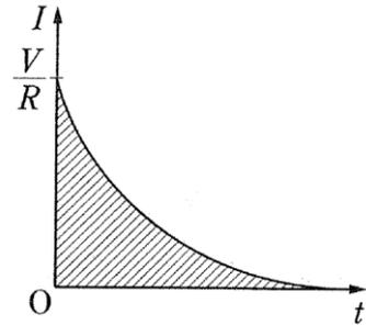
電気量は  $Q = It$  で表される。電流値が変化する場合、 $Q$  は  $I-t$  グラフの面積で求められるから、右図の斜線部分の面積となる。
