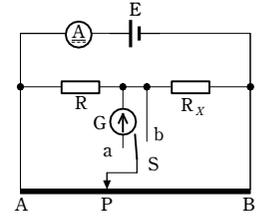
S を a 側に倒し、G に電流が流れないように可動接点 P を調整したところ、AP 間の距離は  $25\text{ cm}$ 、電流計の読みは  $0.30\text{ A}$  であった。 $R_x$  の抵抗値は  $\square$ ア $\text{ }\Omega$  であり、抵抗線 AB の抵抗値は  $\square$ イ $\text{ }\Omega$  である。
